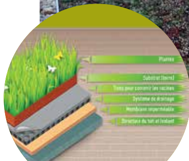
Schéma illustrant la composition d'un toit vert, MDDEFP (2009)
